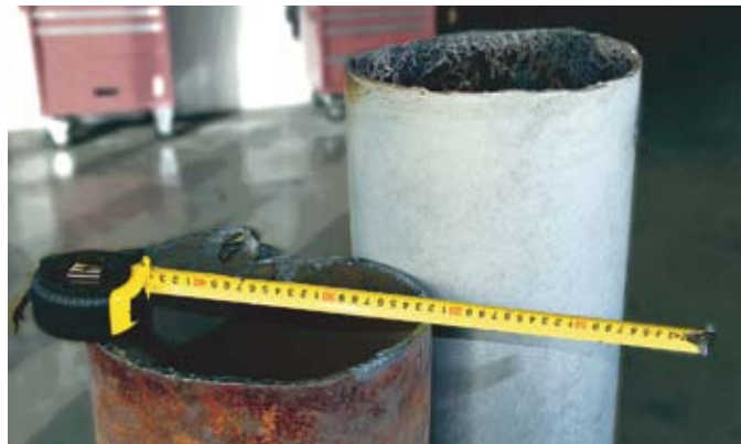
ЗАО «Петроплазма» разработало инновационную технологию плазменной электродуговой очистки металлических поверхностей. На фото — трубы до и после плазменно-дуговой очистки
